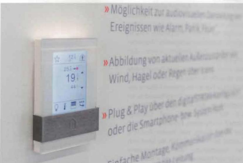
Asera präsentierte unter anderem «Thanos», das erste multifunktionale digitalstrom-kompatible Raumbediengerät aus dem Hause Thermokon. Es umfasst Temperatur- und Feuchtemessung (optional) sowie integrierte Bedienung von HLK, Beleuchtung und Jalousie in der Einzelraumregelung.
